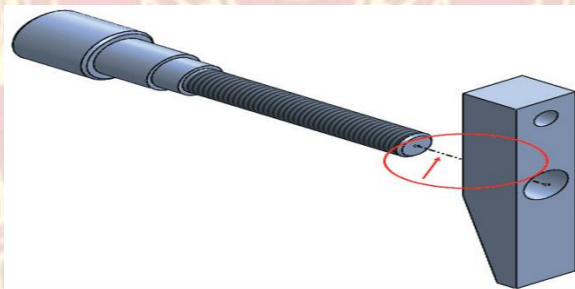
รูปที่ 6.46 แสดงผลการใช้คำสั่ง Explode Line Sketch
