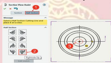
รูปที่ 8.11 การเลือกรูปแบบแนวตัดภาพตัดครึ่ง
